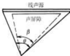
图4-2 受声点与线声源两端连接线的夹角(遮蔽角)
