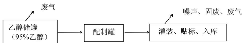
图5-3 95%酒精消毒液工艺流程及产污节点图
