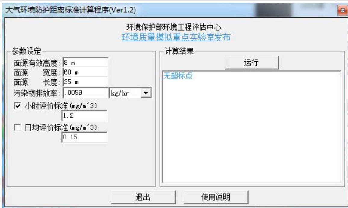
图 7-2 VOCs 大气防护距离计算结果图
