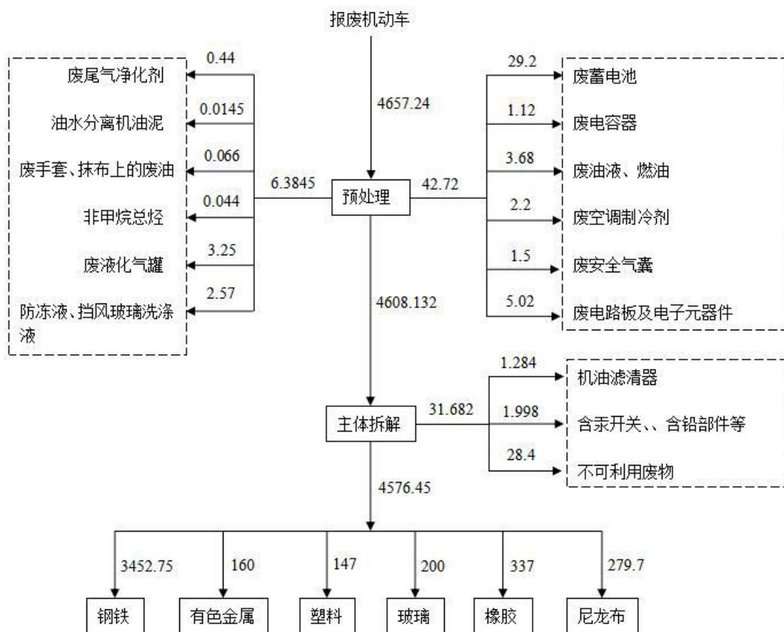
图 4-1 物料平衡图 (t/a)
